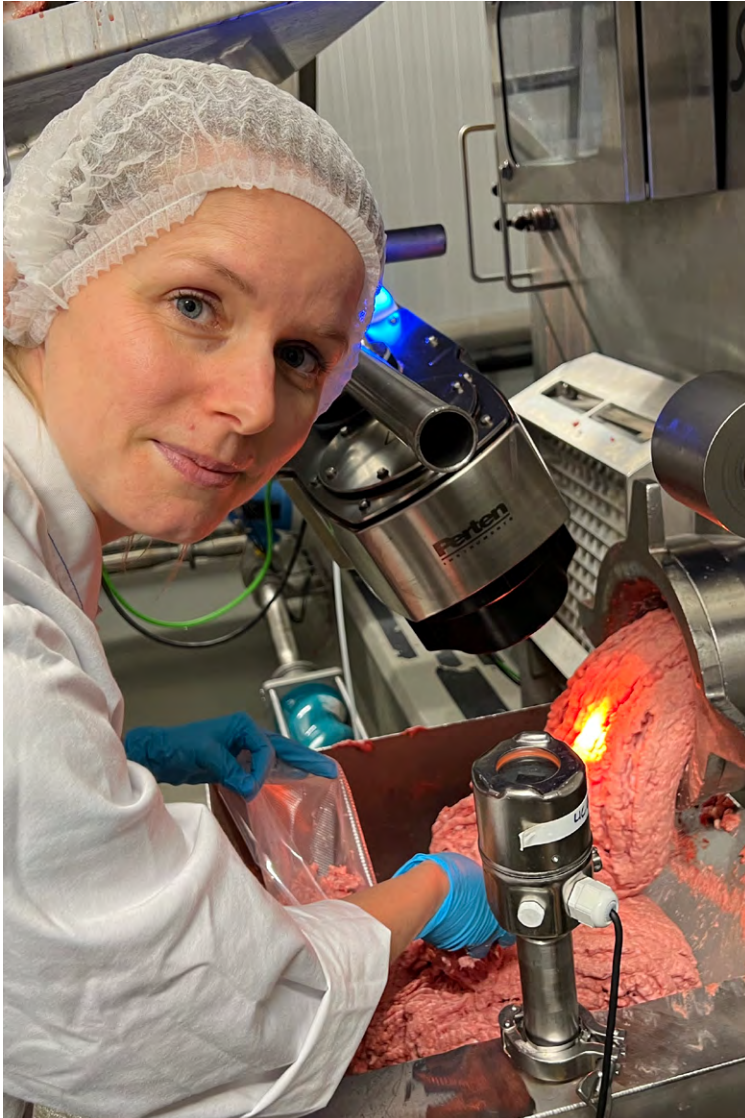
Katinka Dankel viser NIR-sensoren installert hos Bioco. Denne måler kontinuerlig fordelingen mellom utvalgte innholdsstoffer i blandingen.
