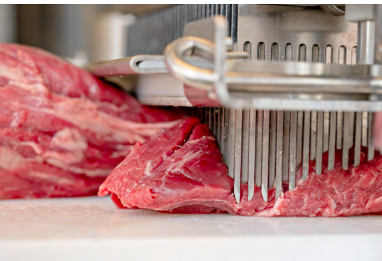
Slik går mekanisk mørning til i Nofimas kjøttthall. Små kniver som sitter tett, skjærer små snitt i kjøttet.
