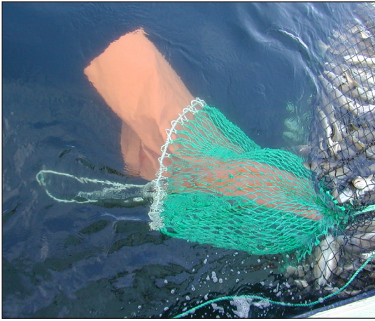
Bilde 22: Løftesekk med presenningsylinder. Løftesekken er åpen i bakkant, og snørt sammen rett foran ringene til løftestroppa.
