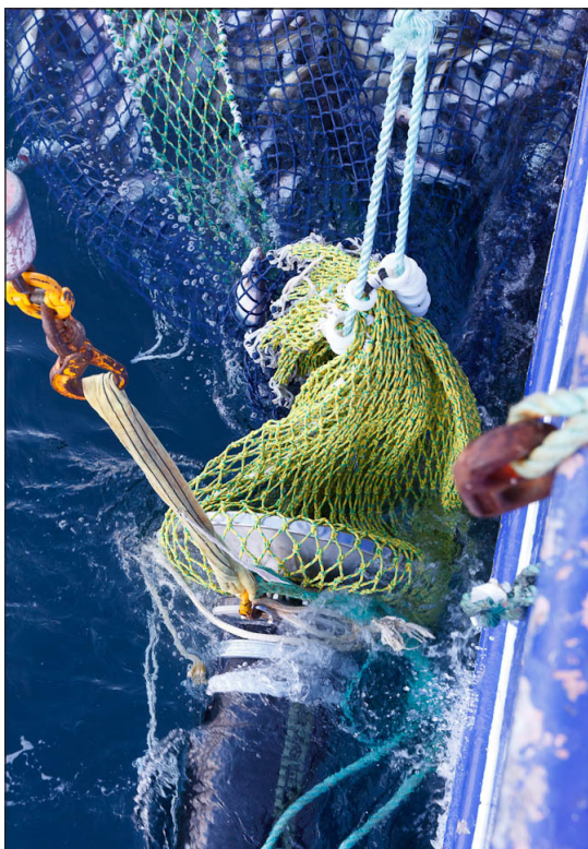
Bilde 27–28: Slangen fra under-/overtrykkspumpen blir festet direkte til snurrevadsens cod-end og lagt langs fartøyets styrbord side. Skipperen tørker sekken på Triplex slik at fisken strømmer uten hindringer om bord.
