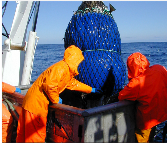
Bilde 23: Løftesekk med innmontert presenningsylinder. Magebånd montert midt på løfteposen for å begrense volum og vekt av fisk i pose.
