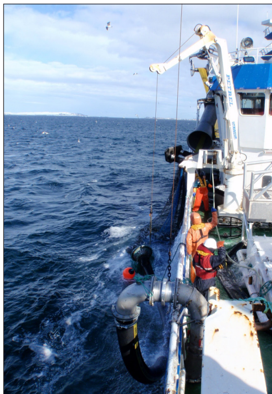
Bilde 27–28: Slangen fra under-/overtrykkspumpen blir festet direkte til snurrevadsens cod-end og lagt langs fartøyets styrbord side. Skipperen tørker sekken på Triplex slik at fisken strømmer uten hindringer om bord.
