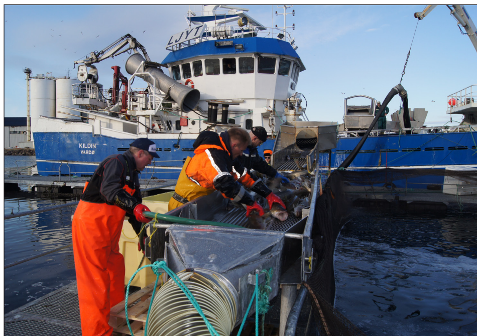
Bilde 48: Mottak for levende fisk må være laget slik at fisken bremses langsomt opp, helst på et fuktig og glatt underlag. Operatørene av anlegget må være trent og øvet i å oppdage fisk som er skadet eller for utmattet/sløv til å overføres til mottaksmerdene.
