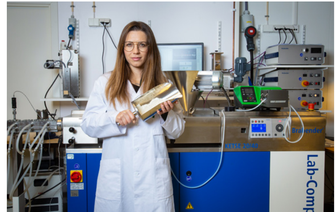
Ekstruderen kan brukes til både tørr- og våtekstrudering. Forsker Catia Saldanha do Carmo har kartlagt effekter ved begge teknologiene
